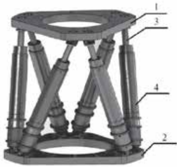
Рис. 1. Гексапод на основі платформи Стюарта: 1 – рухома платформа; 2 – основа; 3, 4 – напівштанги
